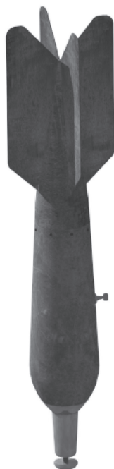
Poreklo: Francuska Odbacivanje: mehanički sa nosača bombi Dejstvo bombe: udarno Kalibar: 75 mm Dužina: 565 mm
